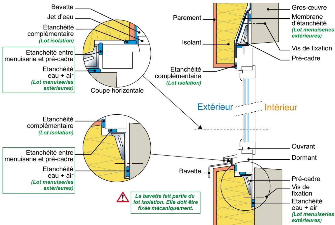
*Exemple de pose de fenêtre en applique extérieure avec pré-cadre avec isolation par l'extérieur de type ETICS (isolant collé sous enduit)*
