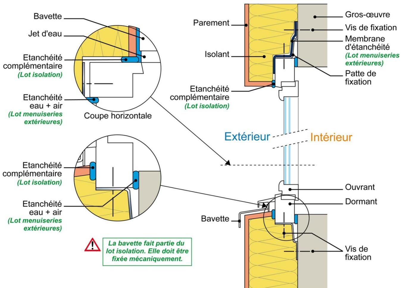
*Exemple de pose de fenêtre en applique extérieure sans pré-cadre avec isolation par l'extérieur de type ETICS (isolant collé sous enduit)*
