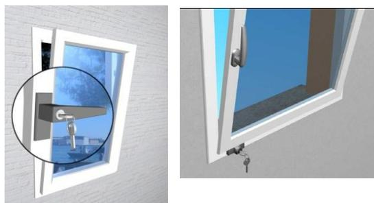
Solution alternative : le système de verrouillage à clé peut être déporté sur le dormant.
