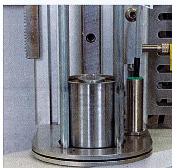
Essai du choc à froid : choc d'une masse tombante de 1kg sur un profilé à -10°C.
