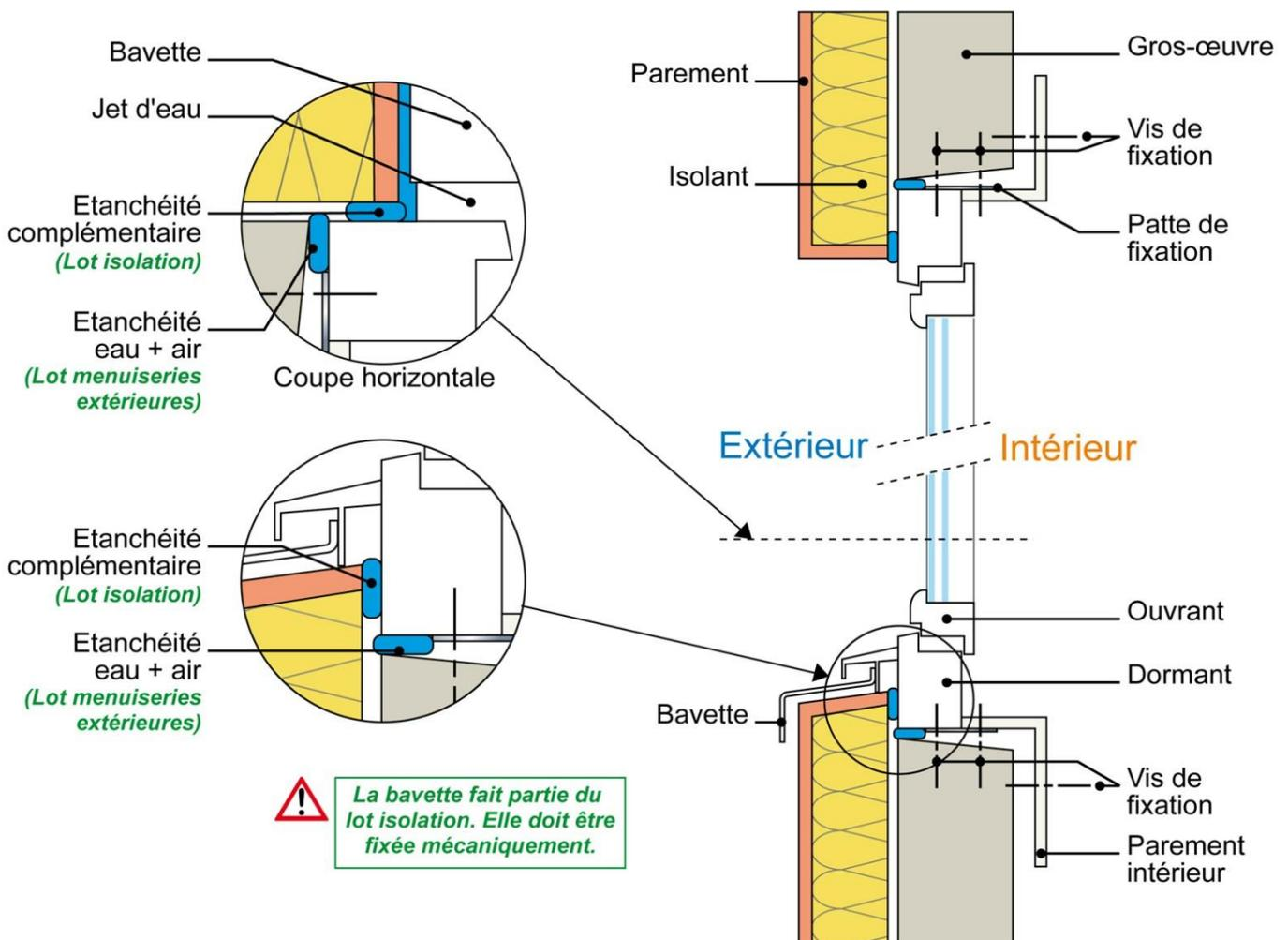
Exemple de pose de fenêtre au nu extérieur du gros œuvre sans coffre de volet roulant avec isolation par l'extérieur de type ETICS (isolant collé sous enduit)
