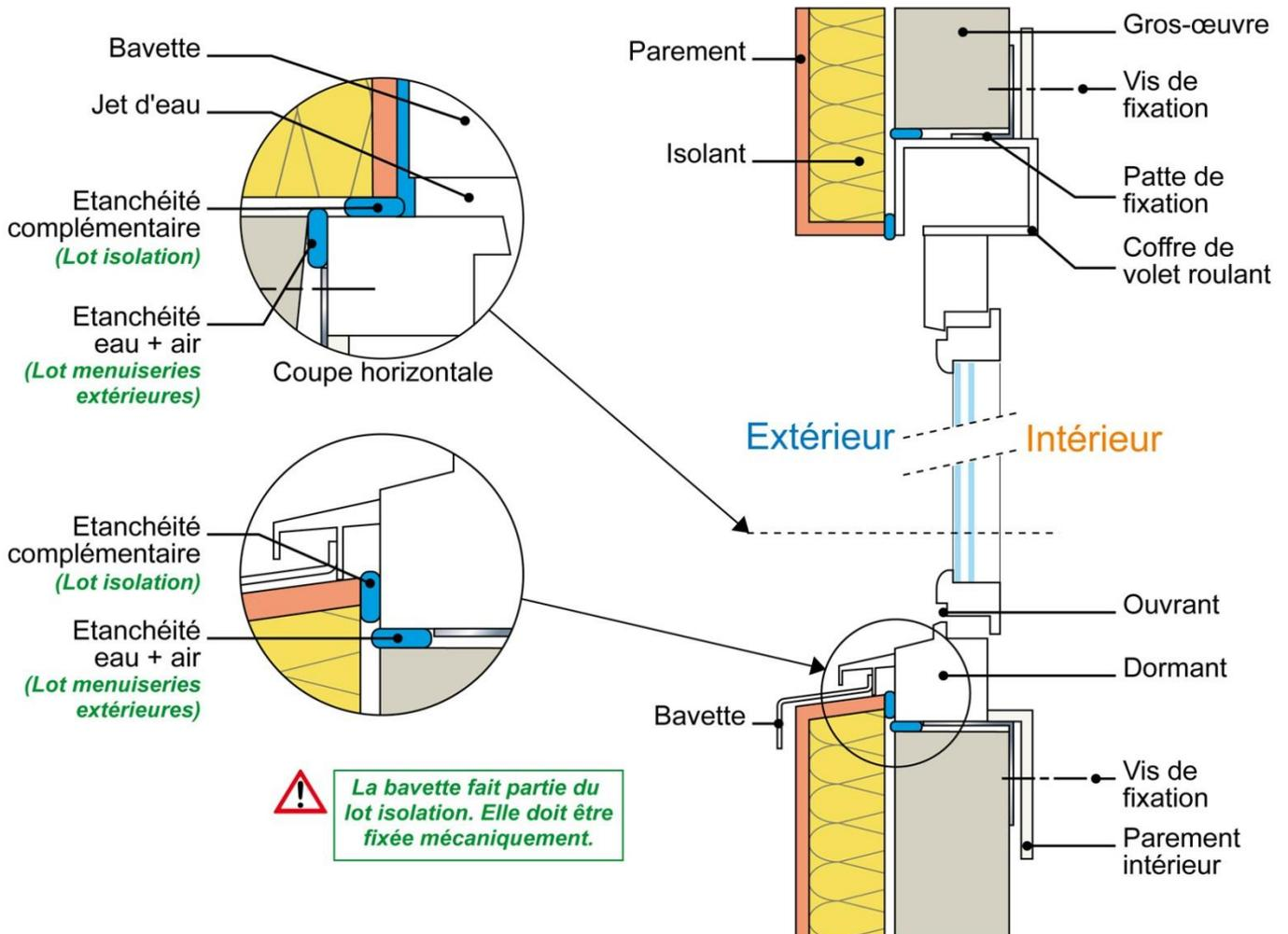
Exemple de pose de fenêtre au nu extérieur du gros œuvre avec coffre de volet roulant avec isolation par l'extérieur de type ETICS (isolant collé sous enduit)
